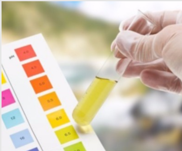
определение значения pH с помощью индикатора
